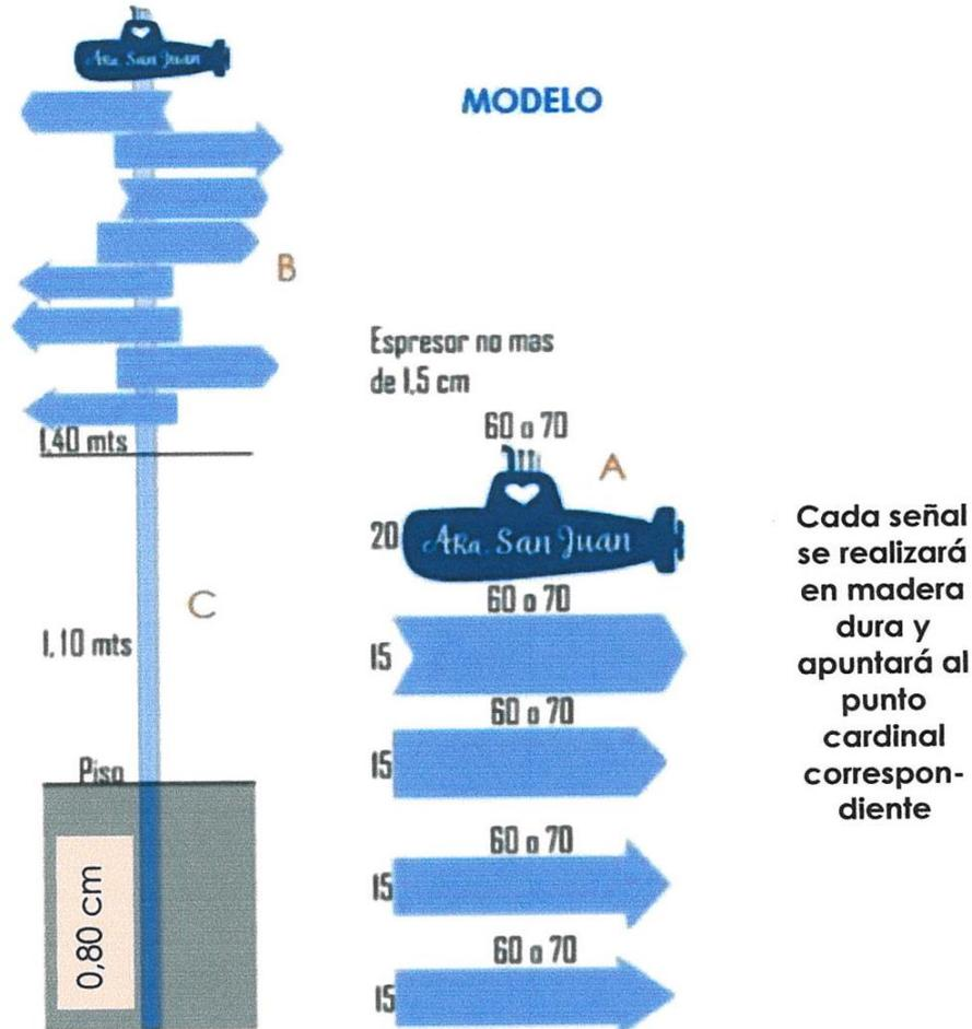
**Base:** 50 x 50 por 0.80 cm de profundidad. De hormigón (0,6 m<sup>3</sup> de piedra, 0,6 m<sup>3</sup> de arena, 6 bolsas de cemento) representan 6 bases de 1 m<sup>3</sup> cada una.
